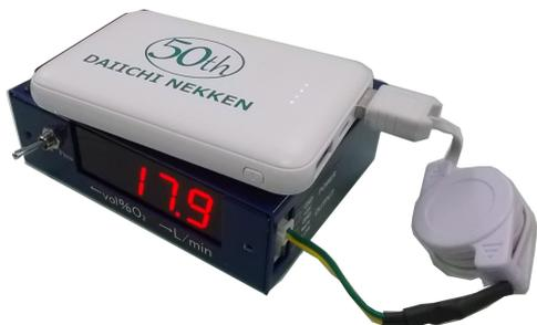
モバイルバッテリー等で濃度測定の前10分前から電源を投入して下さい。
